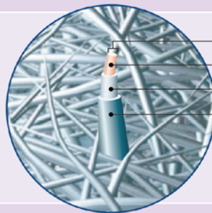
デュポン™タイベック®を 構成する強靱な 極細ポリエチレン繊維 (電子顕微鏡による拡大写真)
