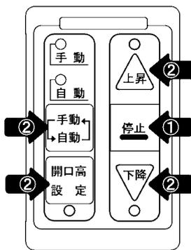
運転モードの状態では、左図のように **停止** を押しながらか **上昇** **下降** **開口高** **手動/自動** の全てのスイッチを3秒位押し続けると「ピー」という音とともに全てのランプが光ります。この後手を離すとランプが全て消え、設定モードになります。
