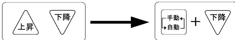
センサーの位置まで下端シートを移動させる。スイッチを押している間間番はゆっくり動作し、手を離すとその場で止まります。
