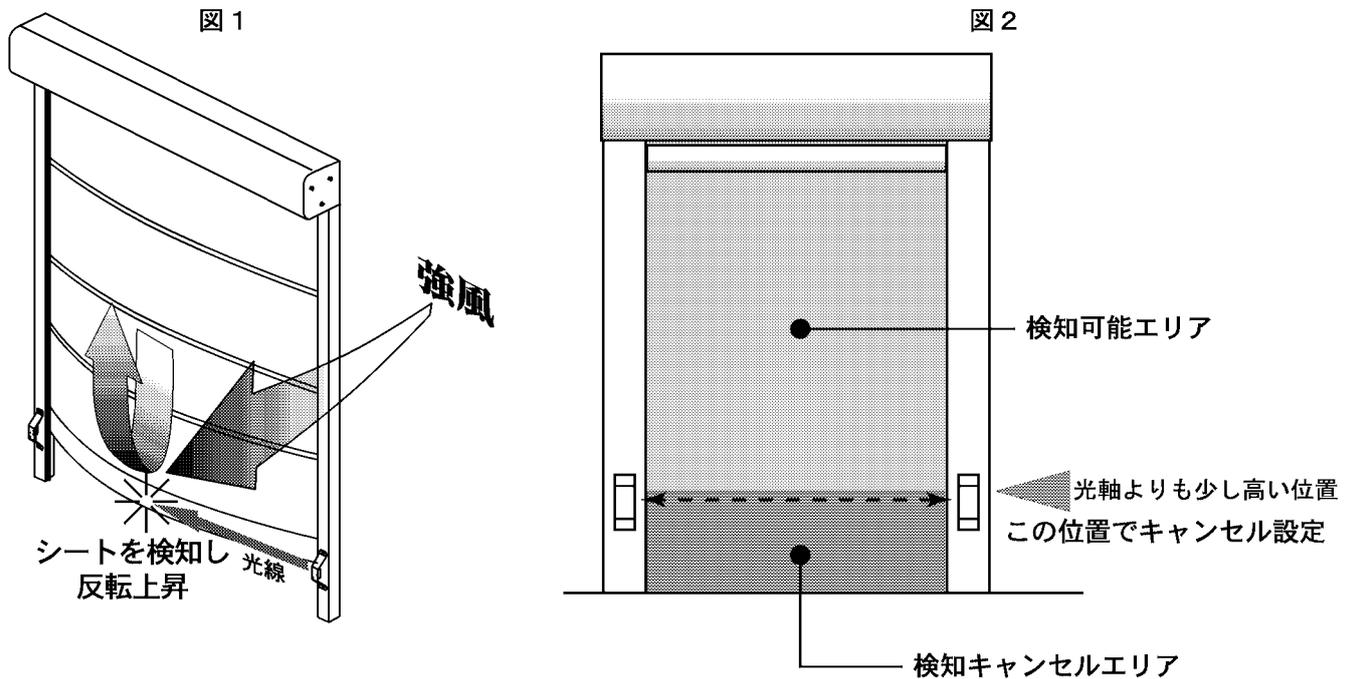
図1のようにシート下降時、強風のため下端シートが光電管センサーの光軸を遮り、反転上昇してしまう場合は光電管センサーキャンセル設定を行うことでこれらの誤動作を防ぐことができます。設定モードで下端シートをキャンセルさせたい光電管センサーの位置まで移動させ、その場所をキャンセルさせる設定を行うことで、図2のように設定位置以下のエリアでは光電管センサーの光軸を遮ってもシートは反転上昇せず、これよりも上のエリアでは検知すると反転上昇します。
