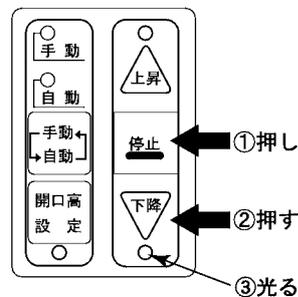
設定したい位置にシートを止めた後、左図のように**停止**を押しながら**下降**を押してください。下降ランプが赤く光り、下限停止位置が記憶されます。
