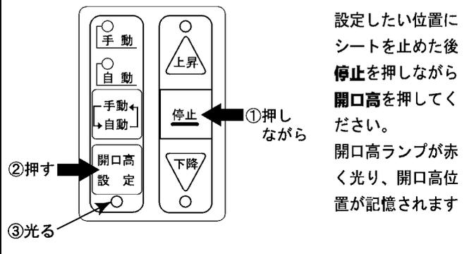
設定したい位置にシートを止めた後**停止**を押しながら**開口高**を押してください。開口高ランプが赤く光り、開口高位置が記憶されます
