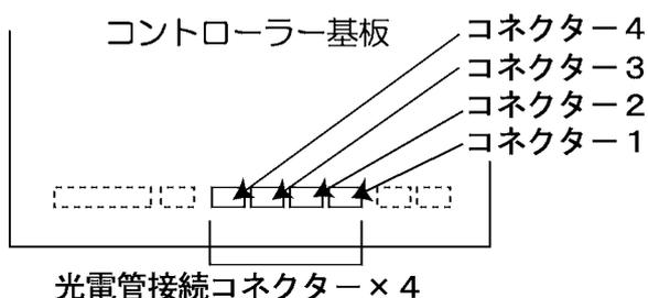
光電管センサーキャンセル設定は、4個あるコネクターに接続したセンサーごとにキャンセルさせることができます。キャンセル設定を行いたいセンサーと、接続してあるコネクターを確認の上で設定を行ってください。
