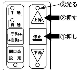
設定したい位置にシートを止めた後、左図のように**停止**を押しながら**上昇**を押してください。上昇ランプが赤く光り、上限停止位置が記憶されます。
